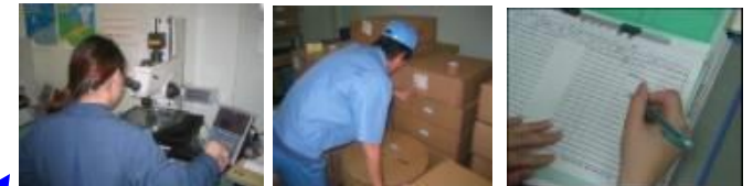
4. 現物確認と情報分析を基にロットを限定。管理課は量産現品、在庫・納品済み品の調査を実施 品管はロット一覧へ「保留品」である旨記載し、製品の凍結を行う(誤作業防止)
